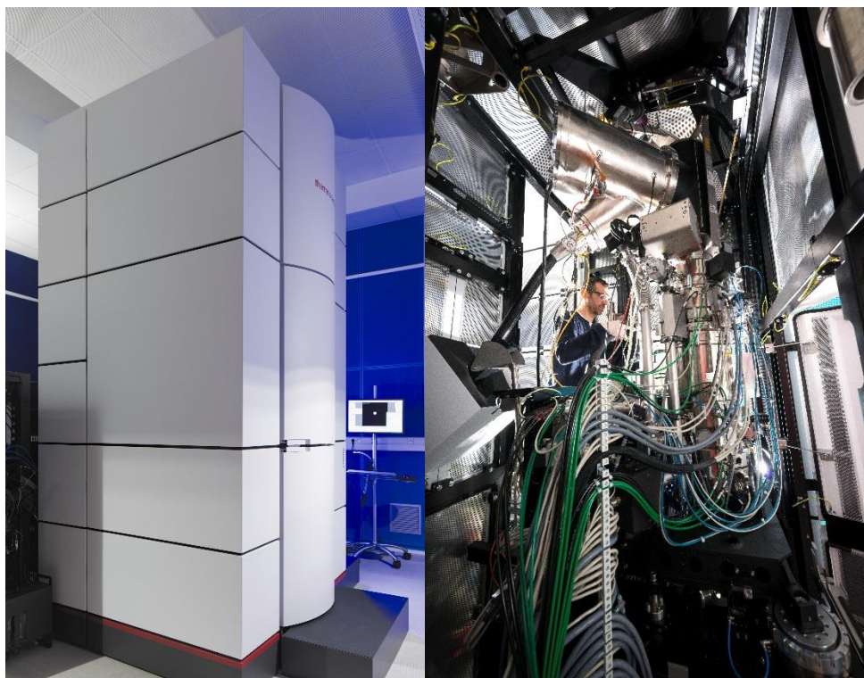
Partie haute du microscope électronique en transmission dans son enceinte acoustique
